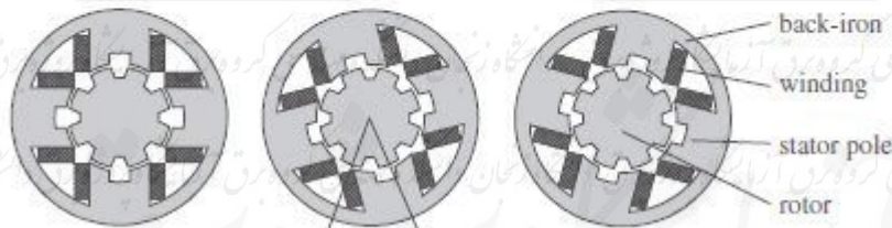
(a) نمای یک موتور پله ای رلوکتانس متغیر با سه دسته به موازات شفت
